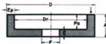
CR COPO RETO TIPO 6 - Forma D DETERMINAÇÃO DAS MEDIDAS D \times A \times F Dr \times Pa E...Ep
