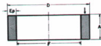
AN ANEL OU CILÍNDRICO TIPO 2 DETERMINAÇÃO DAS MEDIDAS D \times A \times F Ep
